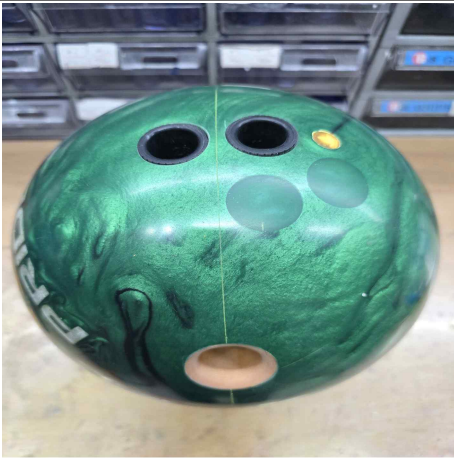
볼링볼 플러깅 불검사 합격 예시 사진
